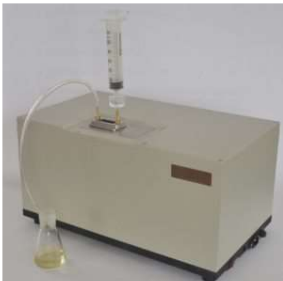
Анализатор на базе ИК фурье-спектрометра Инфраспек ФСМ 2201 с проточной аналитической ячейкой МНПВО
